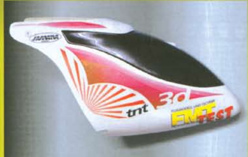
Die GFK-Haube ist leider etwas spröde und reißt an den Befestigungspunkten schnell ein. Hier hat der Hersteller bereits reagiert und bietet andere Exemplare an.
