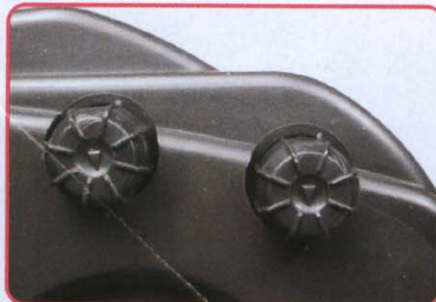
Les trims de direction et des gaz / frein sont de type potentiomètre, faciles à manipuler et situés sur la face avant droite de la radio.
