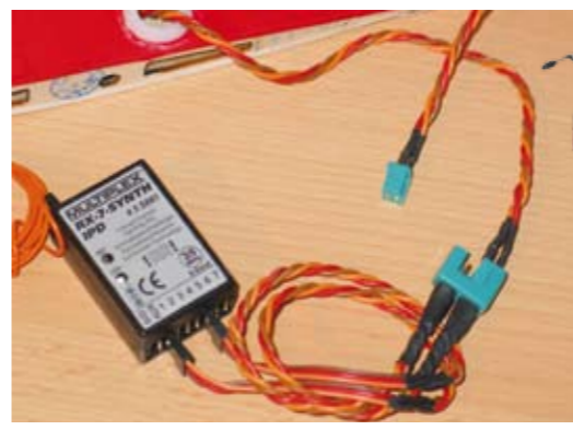
Zur elektrischen Verbindung zwischen Querruderkabel und Empfänger wurde ein MPX-Stecker verwendet. In der Mitte durchgesägt ist eine Verwechslung des linken und rechten Anschlusses ausgeschlossen
