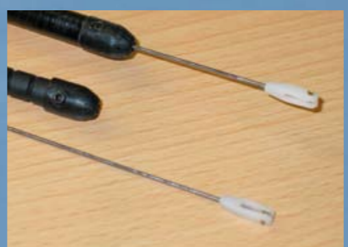
Zur Anlenkung des Höhenleitwerkruaders liegen dem Bausatz ein CFK-Stab und passende Anschlusssteile bei
