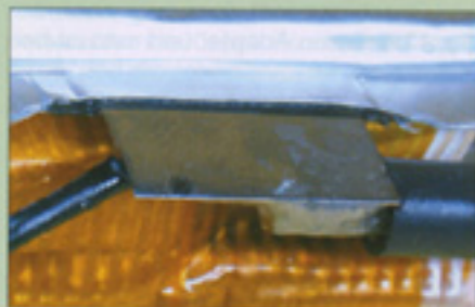
Die massiven Ableiter sind jeweils endständig an den Zellen herausgeführt und werden direkt (ohne Platine) miteinander verlötet. Mit 15 mm Breite und 0,2 mm Stärke haben die Ableiter mit 3 mm 2 auch endlich Dimensionen erreicht, die den hohen Entnahmeströmen gerecht werden. Rechts sieht man das massive 4-mm 2 -Anschlusskabel, links das relativ dünne Balancerkabel
