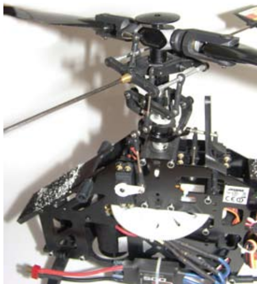
Die Taumelscheibe ist aus Alu gefertigt, die Anlenkung erfolgt über eine direkte Dreipunkt-Anlenkung
