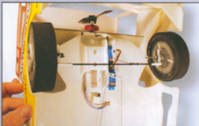
Framvagnen på trucken. Observera acken som ligger förskjutet i sidled.
