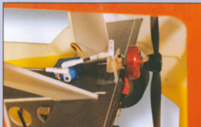
Höjdroderservot och motorvidningen. Motorfästet är limmat mot ett vanligt gängjärn till "kroppen".
