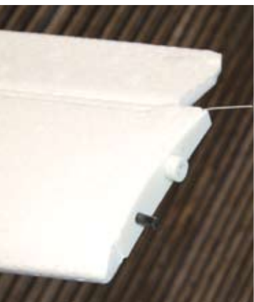
Der Umlenkhebel für die Querruderanlenkung sitzt unter dieser Abdeckung, die unschön aus dem Profilstrack hervorsteht. Hier hilft um der Ästhetik willen nur abschleifen
