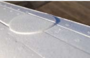
Der Umlenkhebel für die Querruderanlenkung sitzt unter dieser Abdeckung, die unschön aus dem Profilstrack hervorsteht. Hier hilft um der Ästhetik willen nur abschleifen
