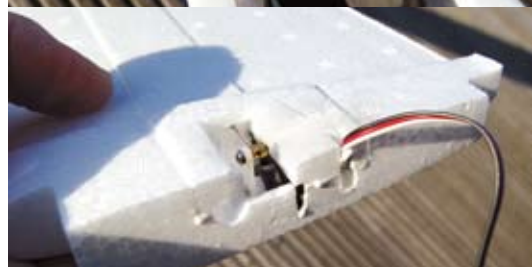
Die Querruderservos sitzen in der Flächenwurzel und steuern diese über einen dünnen Stahldraht und einen 90-Grad-Umlenkhebel an
