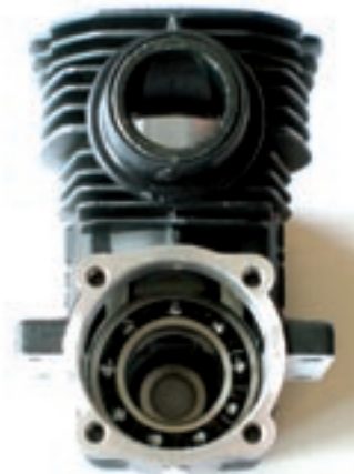
Auch von innen ist das Triebwerk sauber gearbeitet. Die verbauten Kugellager drehen extrem leichtgängig und sind von Werk aus leicht eingölt
