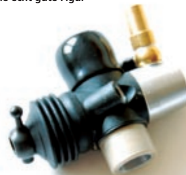
Auch am Vergaserhals wurde nicht mit Keramik gespart. Hier soll die Beschichtung vor Hitze im Vergaser schützen
