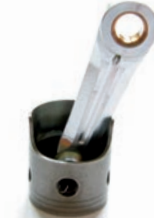
Der matte Look des Kolbens kommt von der Keramikbeschichtung. Diese soll den Verschleiß niedrig halten
