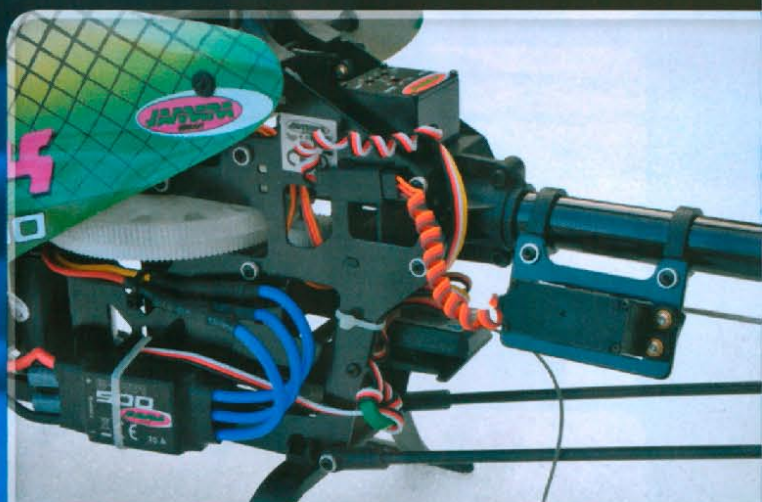
Sauber montiert. Die Servokabel sind zur Spirale gedreht, die Komponenten sicher befestigt.
