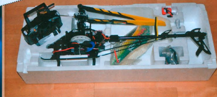
Im Lieferumfang ist außer einem Ladegerät alles Erforderliche enthalten. Selbst die acht Mignonzellen für den Sender fehlen nicht.
