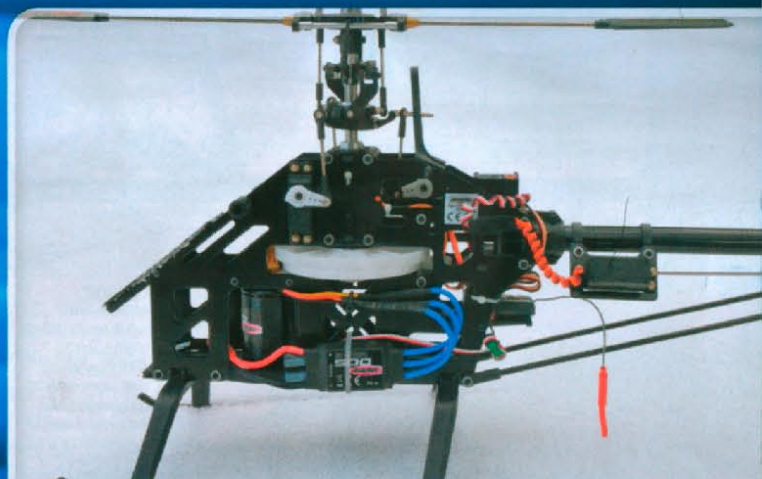
Die Mechanik des E-Rix 500 RTF erinnert an andere Modelle dieser Größe. Ihr Aufbau ist übersichtlich und mechanisch robust.
