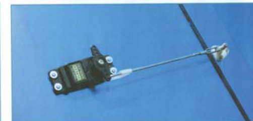
La commande d'ailerons est courte et rigide, ce qui assure un fonctionnement précis. Notez les guignols 3 points !
