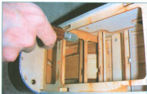
L'entretoise transversale du couple avant est tronçonnée pour permettre la mise en place du réservoir derrière la cloison pare-feu.
