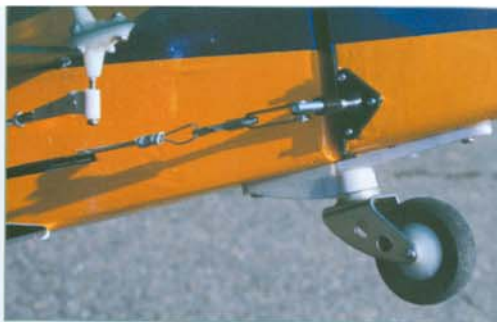
Détail de la roulette de queue, solide et fonctionnelle.
