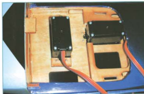
Pour permettre d'installer le servo de profondeur, l'auteur a dû recouper une partie de la barre transversale du plancher support du carénage inférieur.
