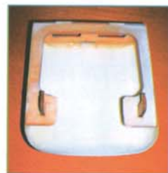
La traverse qui rigidifie le cache de protection en fibre de verre sous le fuselage, doit être recoupée, car il interfère avec le servo de profondeur.
