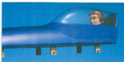
Le capot supérieur du fuselage est fixé par six vis. Ce n'est pas très pratique sur le terrain mais la fixation est sûre ! Le pilote n'est pas inclus dans le kit, et a été ajouté par l'auteur.
