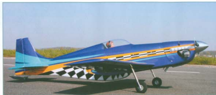
Le Dago vu de profil permet d'observer la position avant du train principal diminuant les risques de passage sur le nez lors du décollage ou de l'atterrissage.
