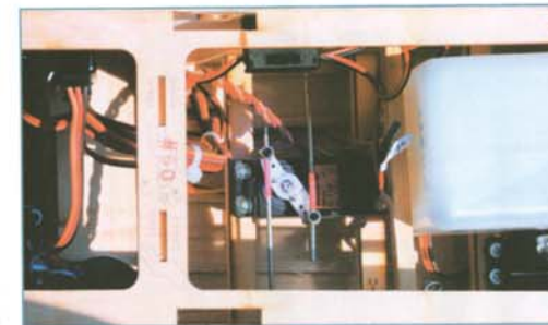
Pour conserver les réglages de train rentrant lors des démontage et remontages, l'astuce consiste à mettre un petit bout de gaine thermorétractable sur les tringleries de train rentrant. Ils serviront de repère. La baguette faisant office de butée est installée derrière le réservoir. En bas à droite de la photo, le servo de gaz.
