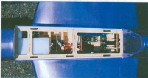
Le fuselage n'est pas très large mais la place est suffisante pour accueillir les éléments de radiocommande.
