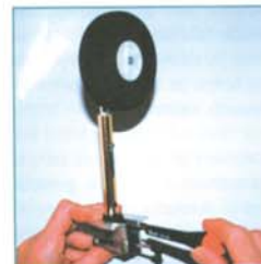
Bien régler les butées de fin de course du train rentrant à l'aide d'une clé Allen. C'est indispensable pour assurer un fonctionnement correct.
