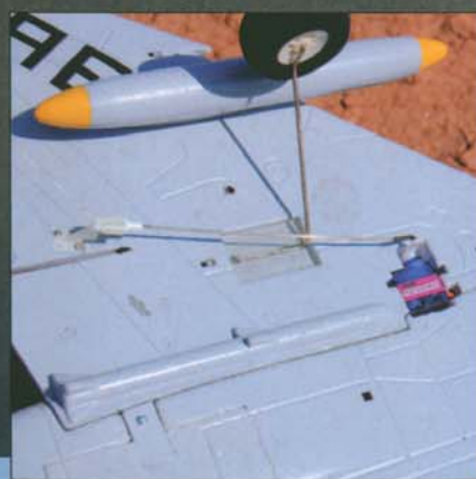
Las superficies de profundidad son gobernadas por un solo servo. Las varillas se conectan a distintos agujeros de los horns para que manden en la misma proporción.
