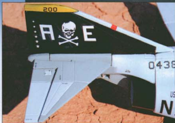
Detalle de la típica cola del avión en forma de V invertida.
