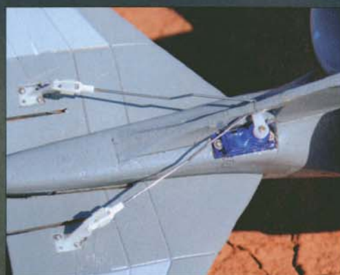
Las superficies de profundidad son gobernadas por un solo servo. Las varillas se conectan a distintos agujeros de los horns para que manden en la misma proporción.
