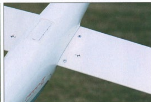
Le système de verrouillage des ailes est très énervant à utiliser, et l'indication du CG sérigraphiée (à l'intrados de l'emplanture) est hélas fautive de plus de 20 mm.
