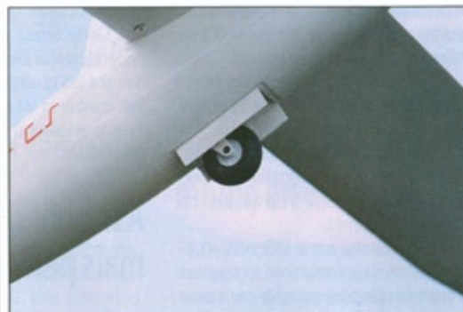
Le train rentrant, avec une fermeture approximative des trappes et un verrouillage un peu léger, est à supprimer pour gagner de la masse.
