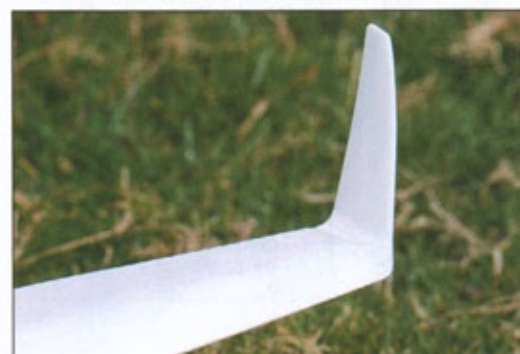
Détail indispensable pour souligner le look de ce planeur moderne d'un allongement de 19,8, les winglets en plastique injecté sont simplement maintenus par un bout de scotch.
