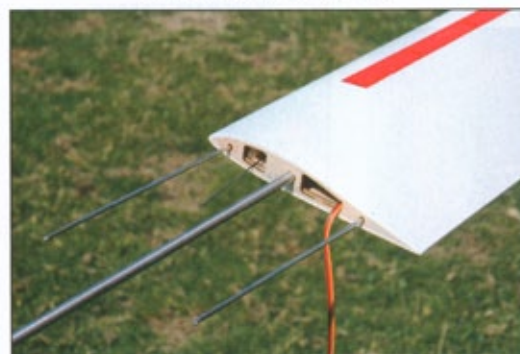
On distingue ici le curieux profil retenu pour ce Discus. Les quatre «tiges» sortant de l'emplanture (clé, système de fixation, commande d'AF) demandent de la patience lors de la mise en place des ailes.
