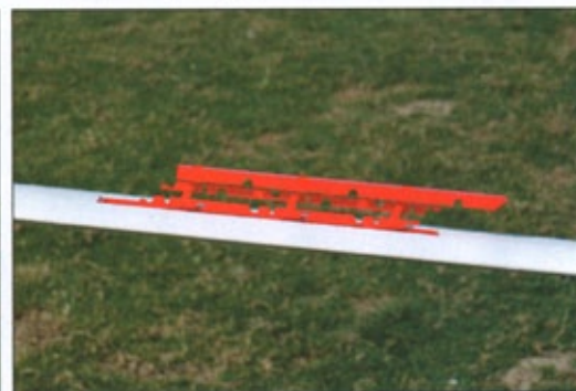
Les AF à lames sont assez efficaces mais demandent un réglage soigneux pour ne pas se déverrouiller en vol. À supprimer pour gagner de la masse, le freinage se faisant alors en relevant les ailerons.
