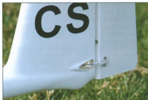
Le volet de dérive est commandé par deux câbles en aller-retour. Il s'est montré peu agréable en vol à cause du dièdre inexistant des ailes.
