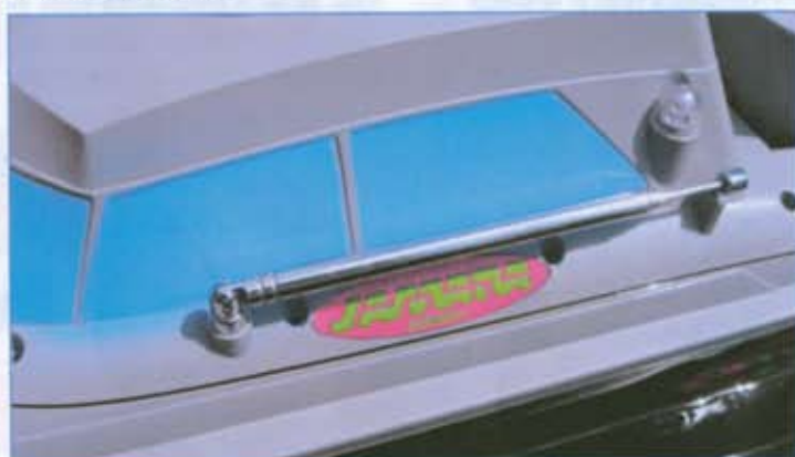
L'antenne de réception, télescopique et sur rotule.
