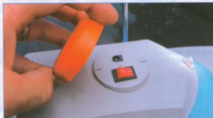
La coupole retirée, accès à la prise de charge et à l'interrupteur de mise sous tension de la réception.
