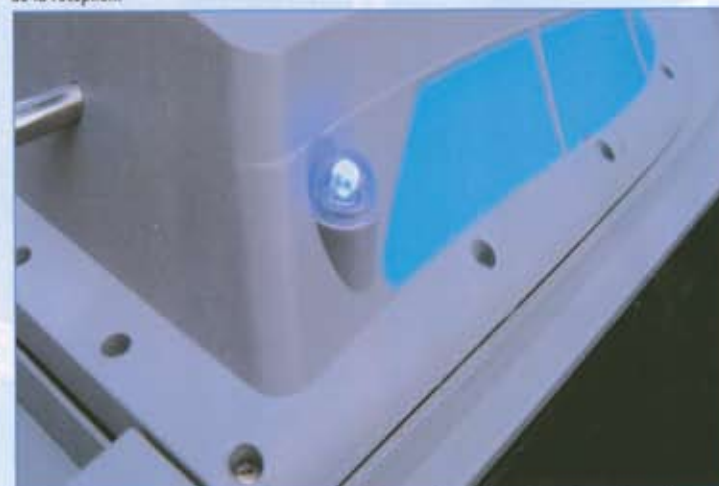
Bâbord et tribord sont implantées des LEDs qui permettent de confirmer les ordres de marche.
