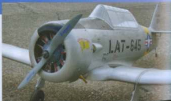
Zwei kleine Ausschnitte in der Sternmotorattrappe leiten die Kühlluft direkt auf die Zylinder des FT 120
