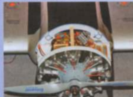
Die Sternmotorattrappe wird am selbst erstellten Akkuträger befestigt
