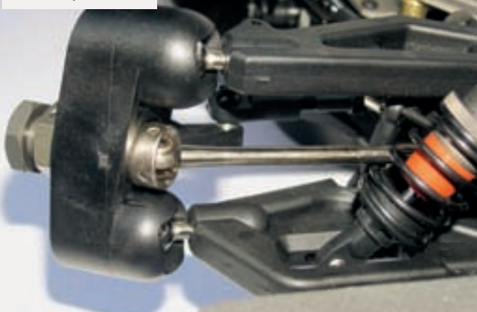
CVD-Kardans übertragen an der Vorderachse die Antriebskräfte
