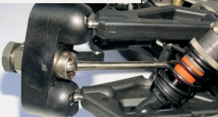
An der Hinterachse gibt es viele Einstellmöglichkeiten. Hochwertige Öldruckstoßdämpfer und ein Stabilisator sorgen für eine satte Straßenlage
