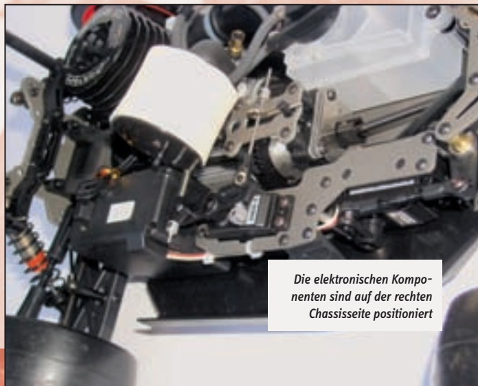
Der CAM-Style Servosaver schützt das Lenkservogetriebe vor Überlastung, ist jedoch in der Härte nicht verstellbar
