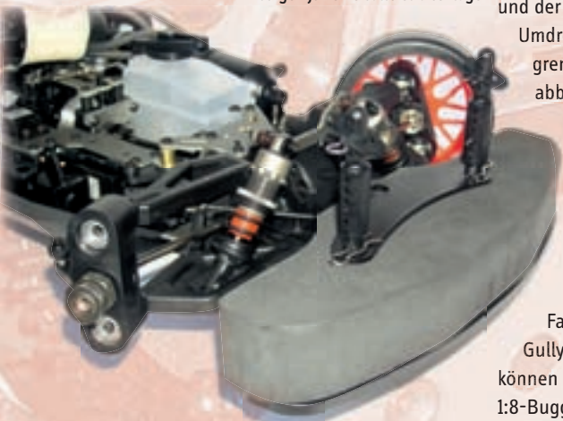
In den Lenkhebeln sitzen die an den Querlenkern eingeschraubten Pivotballkugeln, über die durch die Speichenfelgen hindurch durch Hinein- oder Herausdrehen problemlos der Radsturz justiert werden kann
