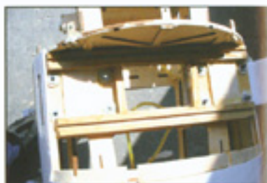
Il est impératif de renforcer la fixation du train qui d'origine s'est avérée trop fragile.
