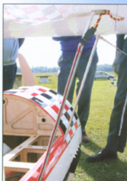
Passage des fils de servos des ailerons supérieurs.
