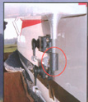
Autre élément de sécurité à remplacer, les guignols qui se fendent rapidement.
