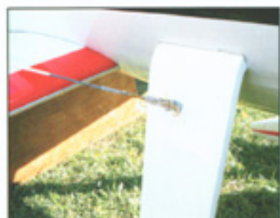
Un des haubans est fixé au train !
