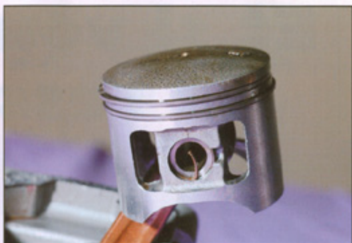
Le piston à double segment. On note aussi l'axe de bielle arrêté par une cap en G.
