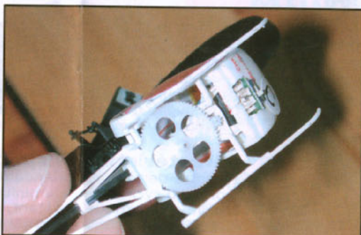
Sous la cabine, l'inter, la prise de charge et l'indication du canal.
