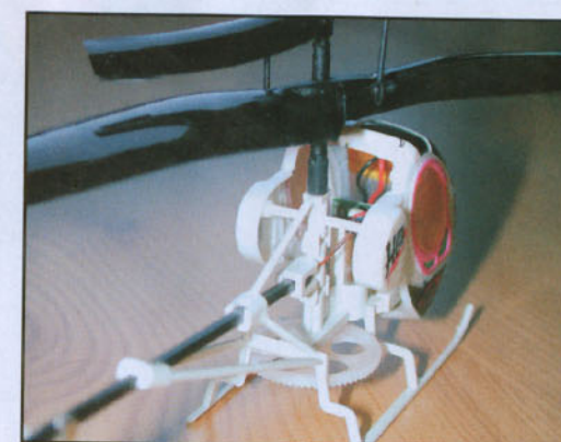
Dans la bulle, on aperçoit l'accu et l'électronique.
