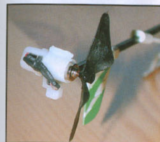
Vraiment petit, le moteur du rotor anti-couple !
