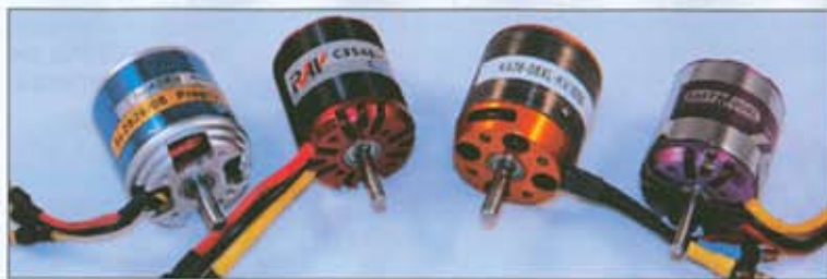
Voici les quatre moteurs essayés, qui ont donné des résultats similaires en vol. Toutefois, deux (Turborix et Ray à gauche sur la photo) ont permis de tester l'avion en 4S, ce qui donne une pêche terrible.
