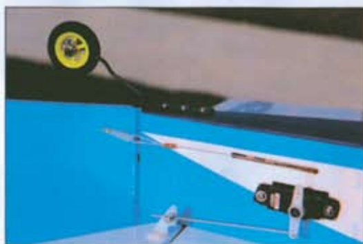
A l'arrière du fuselage, la roulette de queue, la commande par câbles du volet de dérive, et le servo de profondeur.
