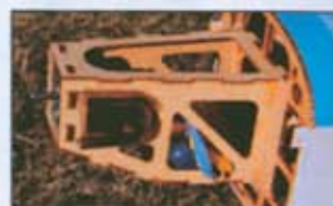
Gros plan sur le bâti-moteur rapporté à l'avant du fuselage et lui aussi très allégé. Ne pas oublier de coller la baguette triangulaire verticale, ni les écopes de refroidissement.
