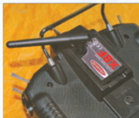
Le module 2,4 GHz est facilement reconnaissable puisqu'il supporte sa courte antenne articulée suivant deux axes et fixée par une virole coaxiale.
