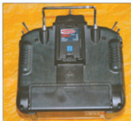
Au dos de l'émetteur se trouvent les classiques bossages ergonomiques de prise en main ainsi que l'emplacement du module HF (ici celui en 41 MHz) protégé par la poignée de transport.
