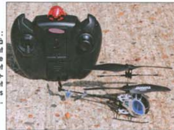
L'hélico répond au doigt et à l'œil grâce à ses trois voies : un pur bonheur. La stabilité est telle qu'on peut tenir le stationnaire d'un doigt (sur le manche des gaz, d'ailleurs un peu ferme), comme ici.
