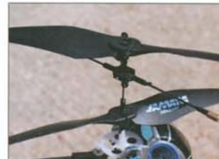
Ce XXS est un véritable birotor (contrairement au Picoo Z), ce qui permet de commander efficacement le lacet.
