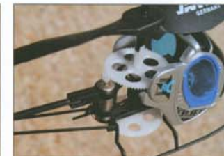
Deux minuscules moteurs entraînent chacun, au travers d'une couronne de démultiplication, les deux rotors contrarotatifs.
