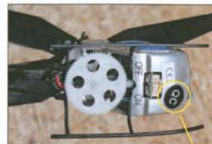
Sous la cabine se trouvent la prise de charge et le micro-interrupteur de mise en marche (ainsi que l'indication de fréquence - ici «C»).
