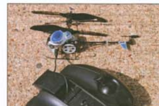
C'est à partir de l'émetteur, doté d'un petit cordon caché sous un volet coulissant en façade, que l'on charge l'hélico en 20 à 30 minutes.
