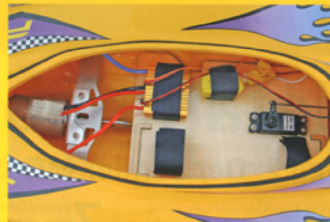
Alle Fernsteuerungskomponenten sind im Lieferumfang enthalten und bereits komplett eingebaut
