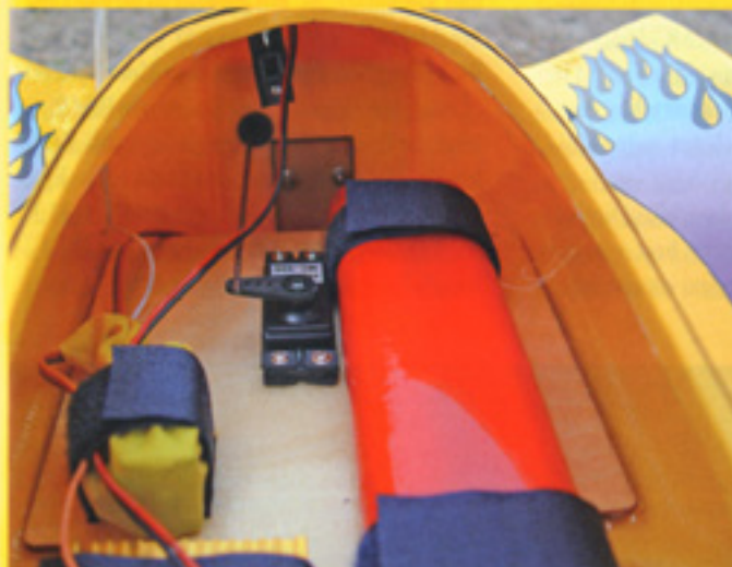
Der 9,6-V/2.000-mAh-Akku findet an der Backbordseite Platz
