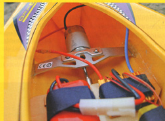
Serienmäßig eingebaut ist ein 600er-Motor, der sich aber natürlich auch durch ein leistungsstärkeres Aggregat ersetzen lässt
