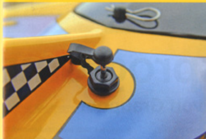
Der Ein-/Ausschalter lässt sich ohne Öffnen der Kabinenhaube betätigen und sichern
