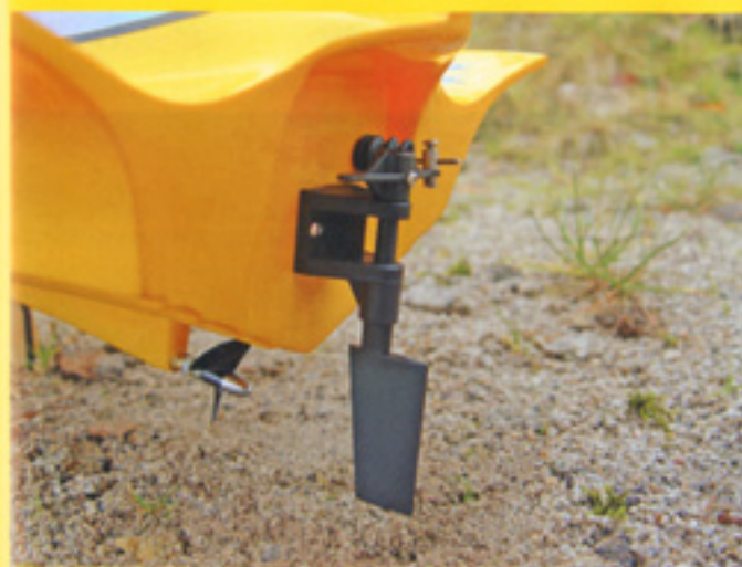
Die Ruderanlage ist stabil und spielfrei ausgeführt
