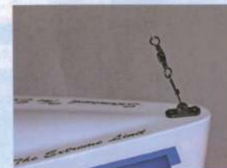
Mit diesen Schäkeln werden die Wanten und Stage befestigt
