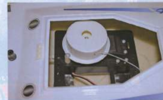
Für die Segelverstellung ist eine Winde zuständig
