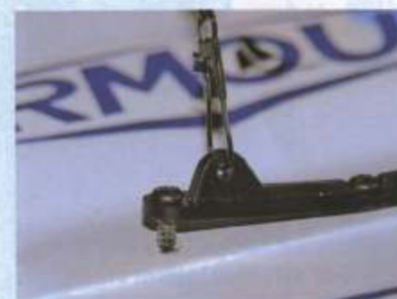
Beim Spannen der Wanten riss eine Befestigungsschraube aus
