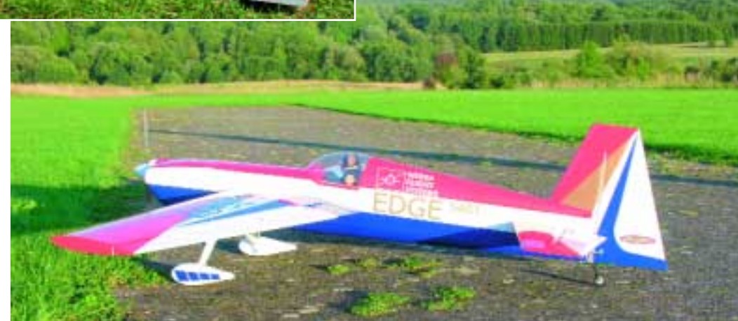
Eine lange abnehmbare Haube macht das Rumpfvorderteil gut zugänglich. Die Klarsichthaube ist übrigens schon passgenau zugeschnitten
