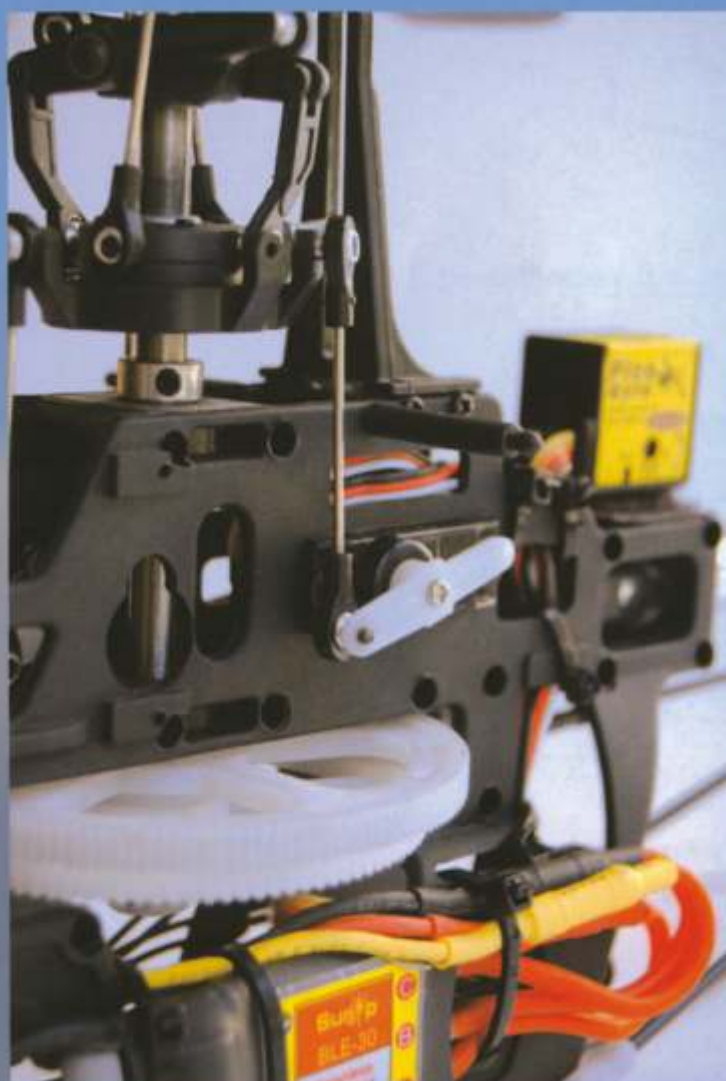
Zweitelliges Chassis aus robustem Kunststoff, einstufiges Getriebe mit Autorotationsfreilauf, Hauptrotor mit 120-Grad-CCPM-Anlenkung, Heckrotorantrieb mittels Zahnriemen – die Konstruktion des Roto 480EP entspricht dem aktuellen Stand der Technik
