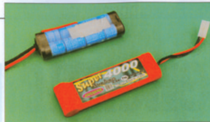
Par rapport au pack «bleu» constitué de 8 éléments Ni-Cd CP-1600 au format 3/4 RC, l'encombrement du pack SunPower 4000 est supérieur mais la capacité emmagasinée 2,5 fois plus importante !
