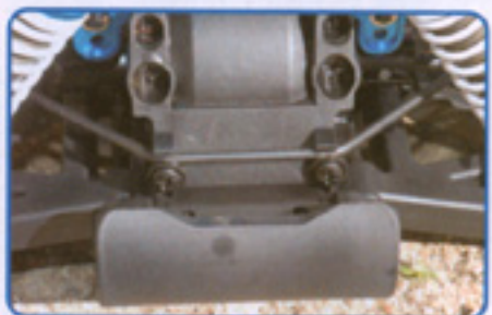
Une barre anti-roulis de 2,5 mm équipe à présent le train avant afin de rétablir au mieux l'équilibre du châssis.
