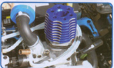
Notre TT est équipé d'un moteur Magnum XLS de 3,5 cc. L'embrayage, le coude d'échappement et les coles moteur sont déjà installés sur l'auto.
