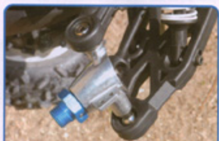
Les porte fusées avant sont encore plus fiables que ceux qui équipent la version LX essayée il y a quelques mois, car ils sont en métal.
