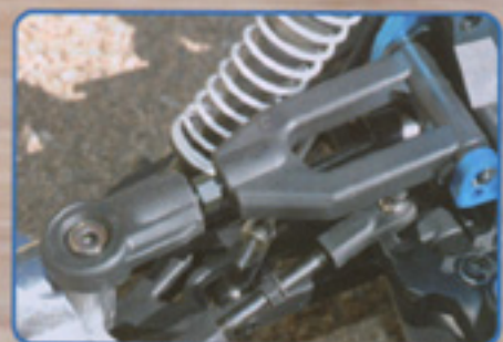
Les triangles inférieurs avant ont changé de physiologie. Leur moyeu s'est étoffé et laisse deviner une forme plus rectangulaire. Même chose en ce qui concerne la chape sur rotule des extrémités, qui est plus imposante.
