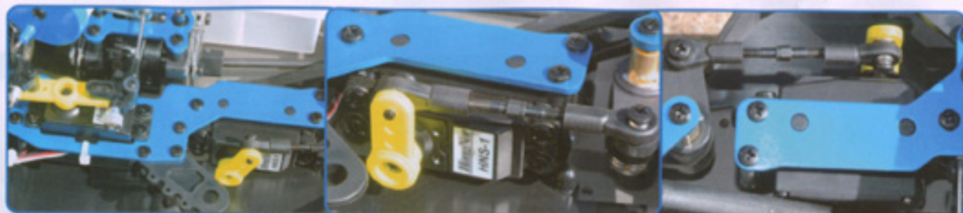
L'aluminium fait partie des composants de l'électronique embarquée à bord, avec une mention toute particulière pour le servo de direction qui se présente en position à plat pour abaisser le centre de gravité.
