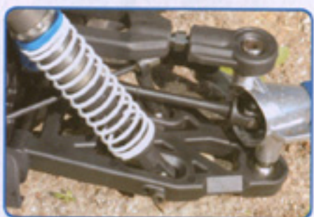
Observez la position complètement décentrée des triangles supérieurs en rapport de celle des bras du dessous sur le train avant. Un agencement qui traduit une modification profonde de l'axe de pivot, pour que l'auto fasse preuve d'une plus grande agilité.
