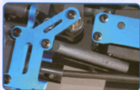
La partie avant du châssis voit débarquer un renfort en nylon greffé sur le renfort du servo.
