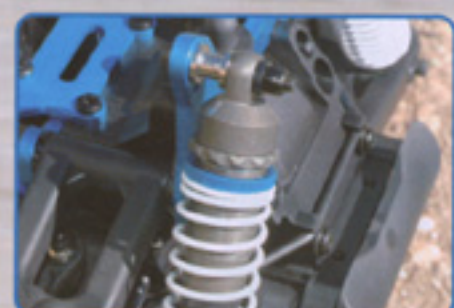
Les amortisseurs intègrent des corps et des bouchons traités, de même qu'un réglage de tension des ressorts qui s'effectue par des molettes filetés freinées par l'intérieur par un joint torique, pour résister aux vibrations.
