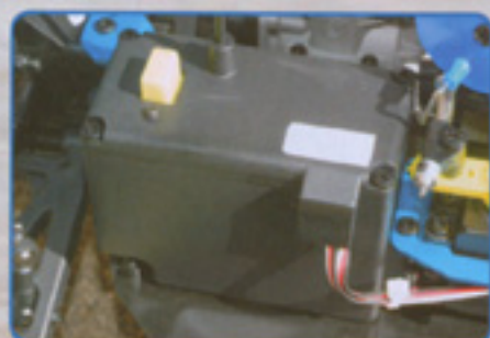
La platine radio reste sobre et a tenu compte de tous les gabarits des récepteurs du commerce dans la mesure où son boîtier est suffisamment spacieux pour pouvoir recevoir côte à côte ces derniers et les occus de l'alimentation.
