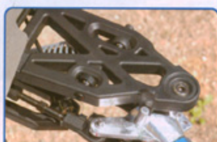
L'armature des nouveaux bras de suspension ne souffre d'aucun reproche. Les triangles inférieurs avant sont légèrement décentrés pour avancer l'axe de roulis, afin d'améliorer la motricité.
