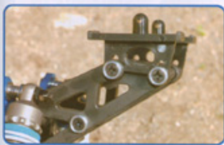
Le support d'aile est allégé et réglable en incidence.
