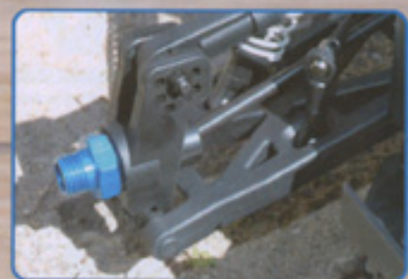
Les porte fusées arrière restent inchangés, mais voient arriver des moyeux de roues qui occasionnent un gain en largeur ou niveau de la voie. Une manière d'accroître la stabilité dans les oppuis.
