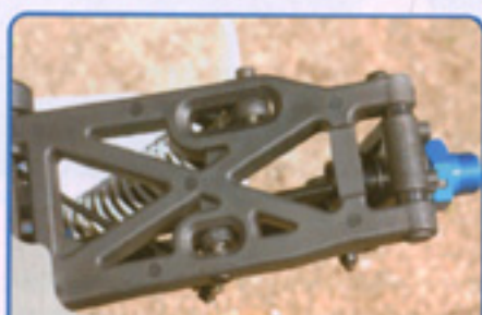
Les nouveaux triangles inférieurs arrière ont également gagné en consistance. Relevez les coles qui autorisent la modification de l'emplacement côté fusée.
