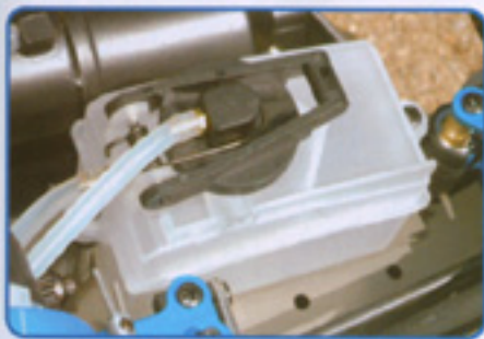
Le réservoir est équipé d'un bouchon de gros diamètre facilitant les ravitaillements, et d'une pressurisation incorporée sur le dessus de celui-ci pour éviter les phénomènes d'engorgement.
